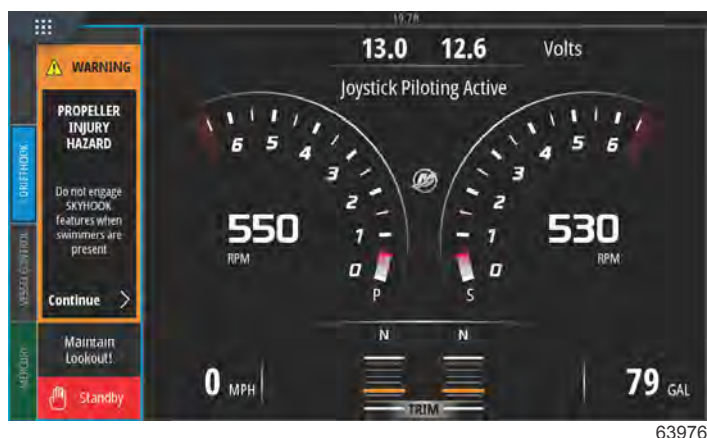
Varning om fara för skador från propellern
