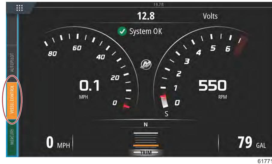
Le mode Cruise Control (Régulateur de vitesse) peut être désactivé en plaçant les manettes de commande à distance en position de point mort ou en sélectionnant le pavé Disable (Désactiver) en bas de la barre du régulateur de vitesse. Pour accéder au pavé Disable (Désactiver), sélectionner l'onglet Vessel Control (Commande du bateau) sur le côté gauche de l'écran pour afficher la barre du régulateur de vitesse et l'option Disable (Désactiver).
