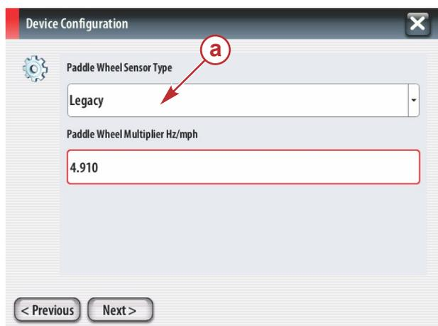
a - Campo do tipo do sensor da roda de pás
