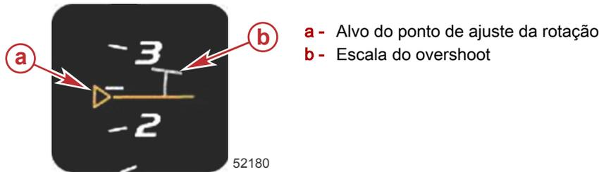
O alvo do ponto de ajuste da rotação mudará de um contorno, quando não ativo, para sólido quando ativado.
