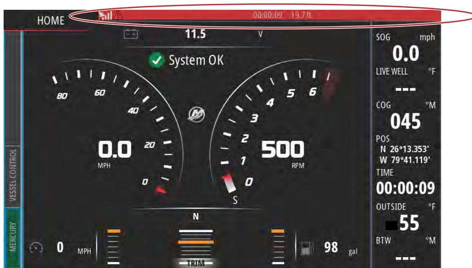
Para ver el fallo seleccione la pantalla del menú principal y seleccione la opción Alarms (Alarmas). Aquí se ve el fallo y la configuración con la que se detectó el fallo puede cambiarse.
