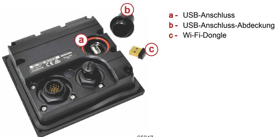
**WICHTIG:** Drahtlose Software-Updates für den VesselView werden über den Wi-Fi-Dongle im USB-Anschluss durchgeführt. Um die Drahtlosfunktion nutzen zu können, muss der Dongle richtig im USB-Anschluss eingesteckt sein.
