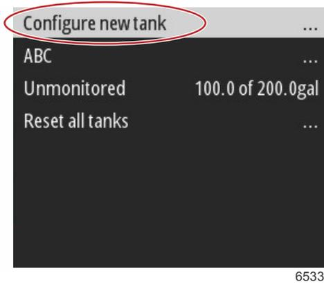
La pantalla de configuración del depósito contiene toda la información que necesita VesselView para mostrar datos precisos sobre el depósito.
